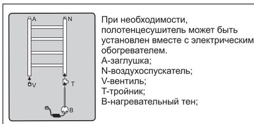
При необходимости, полотенцесушитель может быть установлен вместе с электрическим обогревателем.
